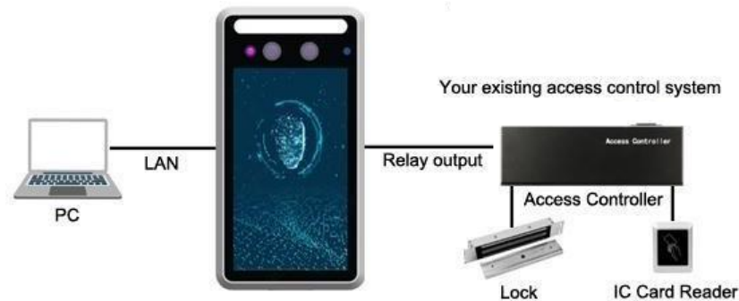
Installazione con sistemi di controllo accessi esistenti
