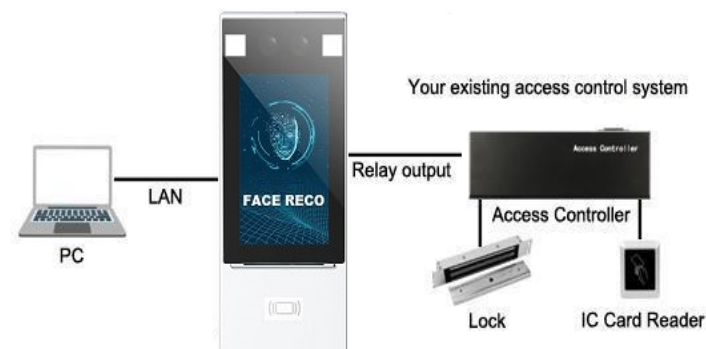
Installazione con sistemi di controllo accessi esistenti
